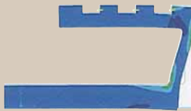
Verformung des Schachtanschlusses in der FEM-Analyse (Bild: Plasson)
