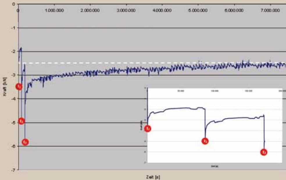
Rückstellkraft gemessen an einem Probekörper
