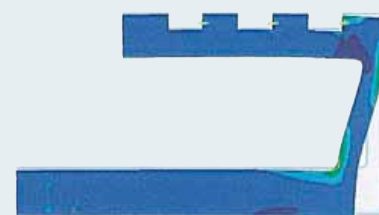
Die praktischen Versuche bestätigten das Ergebnis einer FEM-Analyse zur Verformung des Adapters, die im Zuge der Produktentwicklung durchgeführt worden war.
